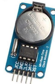
Gambar 7. Bentuk fisik RTC [6]
